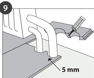
Falls sie einen Abschnitt an Bauteilen wie Heizkörperrohren, Pfeilern o.ä. anpassen, achten Sie bitte auch hier auf den Abstand von mind. 5,0 mm oder mehr und verkleben diesen abschließend an den Schnittstellen.
