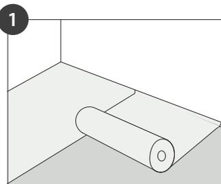
Bei aufsteigender Feuchtigkeit aus dem Estrich verwenden Sie die Aqua-Stop Folie wie beschrieben. Die Folie sollte an den Wänden mind. 2cm hochgezogen werden und an den Stoßfugen mind. 10 cm überlappen.
