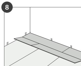
Ist die zweite Reihe komplett fertig gelegt, wird die Reihe von links nach rechts mit der ersten Reihe verbunden. Hierzu heben Sie die verriegelte Plankenreihe leicht an, schieben die Feder in die Nut und senken es ab. Setzen Sie diesen Vorgang für die gesamte Raumlänge fort und entfernen zum Schluss die Abstandskeile.
