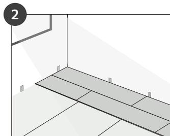
Die empfohlene Verlegerichtung ist längsseitig zur einfallenden Hauptlichtquelle. Als maximale zusammenhängende Verlegefläche empfehlen wir 10,00mtr. x 10,00mtr. Größere Flächen darüber hinaus bedürfen der Absprache und Freigabe durch unsere Anwendungstechnik. Zu allen aufstrebenden Bauteilen, wie Wände, Säulen oder Türdurchgängen sowie angrenzenden Flächen müssen entsprechende Dehnungsfugen fachgerecht eingebaut werden.
