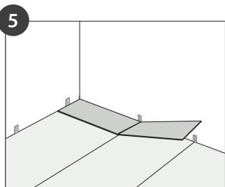
Die Planken der ersten Reihe werden zuerst auf der kurzen Stirnseite verbunden. Es wird in einem Winkel von 25° angesetzt und eingeschwenkt. Achten Sie darauf, dass diese auf der Stirnseite exakt gerade ausgerichtet sind.
