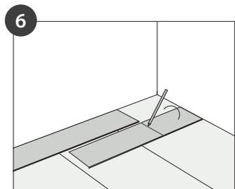
Markieren Sie die letzte Planke der Reihe nach dem Messen und kürzen diese passgenau. Das Reststück der Planke kann den Anfang der nächsten Reihe bilden, sofern es ausreichend lang ist.
