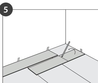
Markieren Sie die letzte Planke der Reihe nach dem Messen auf der Rückseite und sägen diese passgenau. Das Reststück der Planke kann den Anfang der nächsten Reihe bilden, sofern es ausreichend lang ist.
