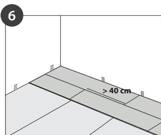
Bitte beachten Sie das der Fugenversatz mind. 40cm beträgt. Die nächste Planke wird wieder zunächst längsseitig in einem Winkel von ca. 25°-30° angesetzt und noch vor dem endgültigen Einklicken an die kurze Stirnseite gedrückt bevor es endgültig runtergedrückt wird (Fold-Down System).
