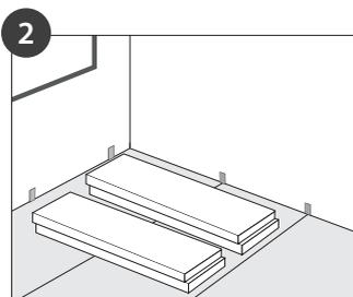
Wir empfehlen bei der Verlegung die Planken wechselweise aus mind. 3 verschiedenen Paketen zu entnehmen und zu mischen, um das gewünschte Dekorbild zu erlangen.
