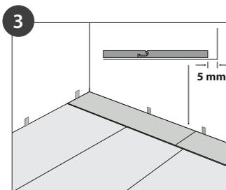
Entfernen Sie bei der ersten Plankenreihe die wandseitige Feder und lassen beim Verlegen einen Wandabstand von mind. 5,0mm.
