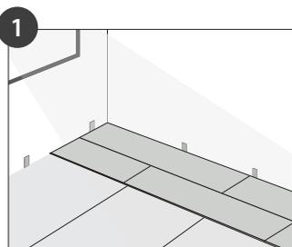
Die empfohlene Verlegerichtung ist längsseitig zur einfallenden Hauptlichtquelle. Als maximale zusammenhängende Verlegefläche empfehlen wir 10,00mtr. x 10,00mtr. Größere Flächen darüber hinaus bedürfen der Absprache und Freigabe durch die Anwendungstechnik. Zu allen aufstrebenden Bauteilen, wie Wände, Säulen oder Türdurchgängen sowie angrenzenden Flächen müssen entsprechende Dehnungsfugen fachgerecht eingebaut werden.
