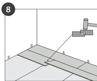
Nach der endgültigen Installation der Plankenreihe ist es sinnvoll nochmal abschließend mit einem weichen Gummihammer und Schlagklotz die Klickverbindung anzuklopfen, damit die Planken höhengleich und fugenlos fest verbunden sind.
