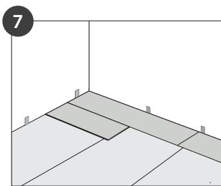
Nach dem runterdrücken der Planke ist es sinnvoll nochmal mit einem weichen Gummihammer sicherzustellen, dass die Verriegelung eingearastet ist und beide Planken höhengleich liegen.
