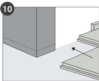
Beim anpassen von Planken an Türzargen ist ebenfalls der Randabstand von mind. 5,0mm einzuhalten. Holz-zargen können auch alternativ unten gekürzt werden. Bei Metallzargen sollten die Fugen mit entsprechender Dichtungsmasse farblich passend versiegelt werden.
