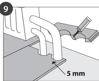
Falls sie einen Abschnitt an Bauteilen wie Heizkörperrohren, Pfeilern o.ä. anpassen, achten Sie bitte auch hier auf den Abstand von mind. 5,0mm und verleimen das angesetzte Stück abschließend an den Schnittstellen.
