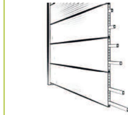
5a | Die Verstärkung in der ersten Füllung im unteren und mittleren Bereich einführen. Die Abstände der Verstärkung für das zweite und dritte Steckzaunprofil jeweils dritteln.
