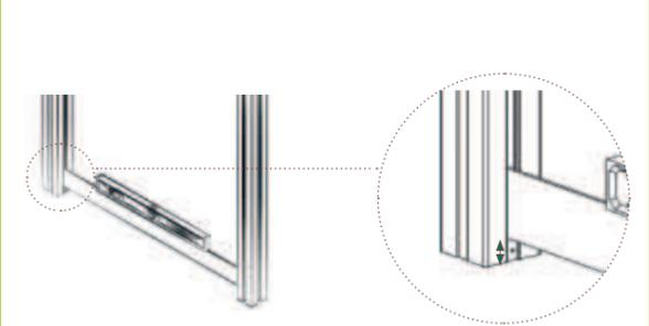
4 | Zuerst auf einer Seite das Distanzstück befestigen. Das Distanzstück der zweiten Seite mit Hilfe eines Füllungselementes und einer Wasserwaage ausrichten und befestigen.
