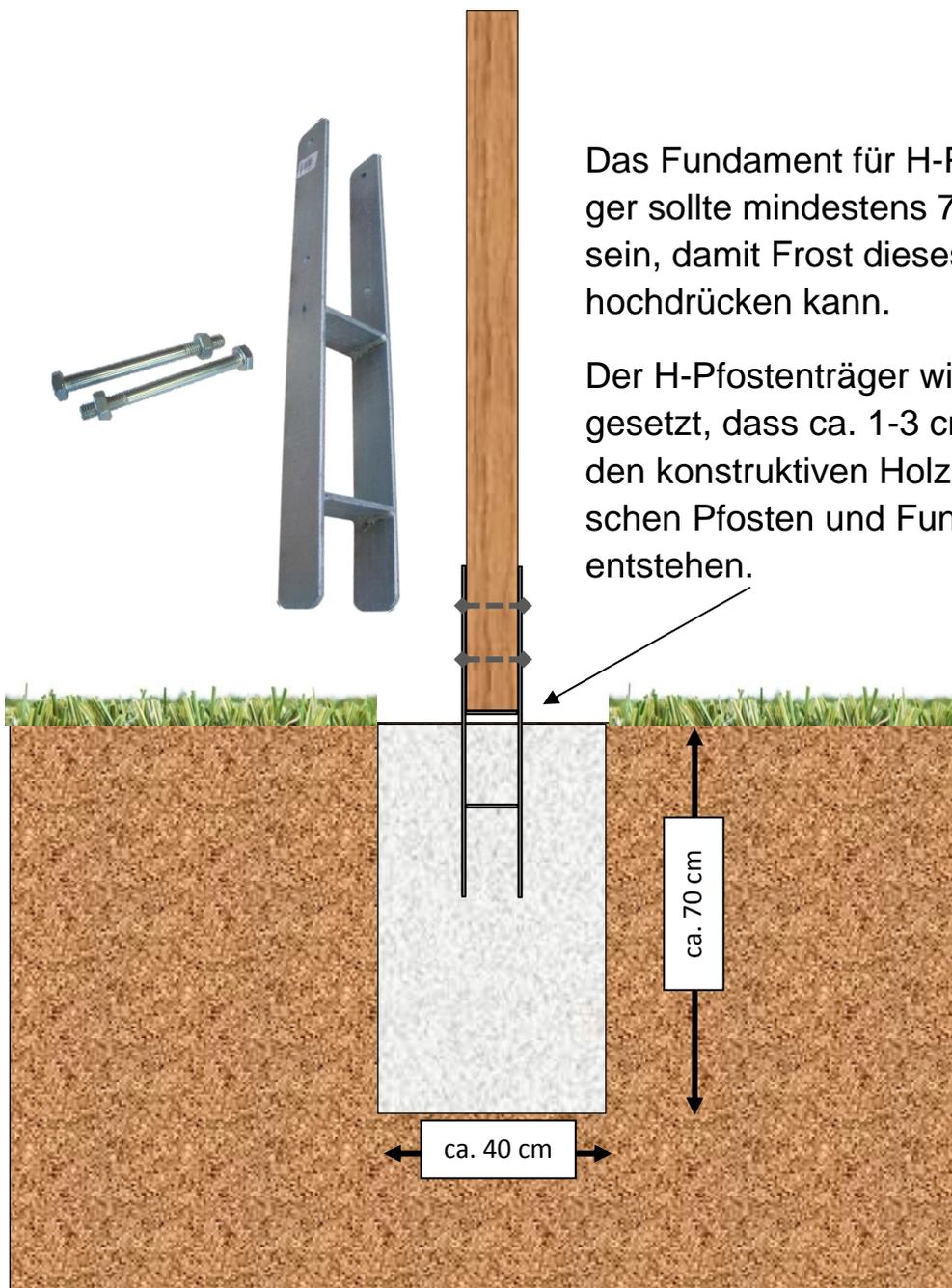
Diese Pfostenmontage ist für alle Zaunanlagen mit Sichtschutzelementen zu empfehlen, welche höher sind als 120 cm.
