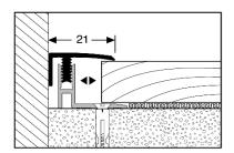
Bezeichnung: Mono – Clip; 2-teiliges Clipprofilsystem aus Aluminium
